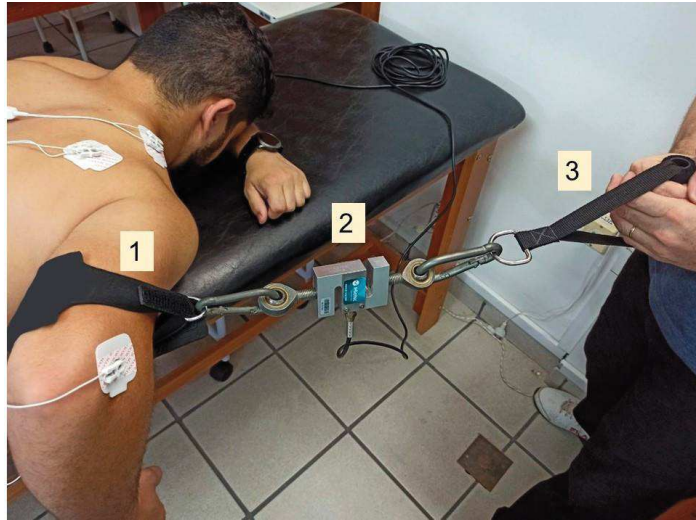
Figura 6 - Posicionamento da célula de carga
