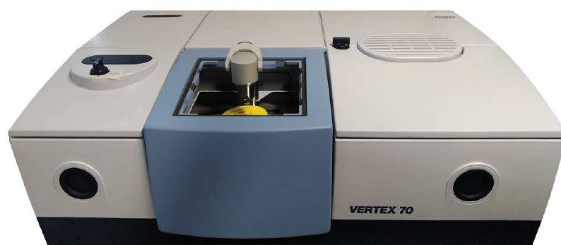
Figura 17 - Espectrômetro de infravermelho médio por transformada de Fourier (FT-MIR) da Bruker, modelo VERTEX 70. Fonte: (BRUKER, [s.d.]).
