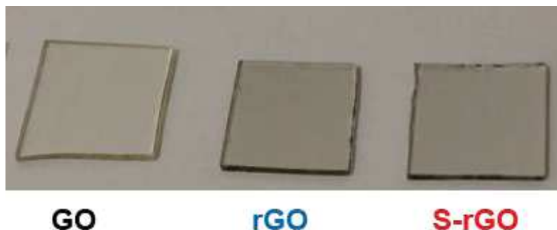
Figura 19: Filmes de GO, rGO e S-rGO. Os filmes foram produzidos utilizando 1 ml de solução em 0.1 mg/ml. Figura produzida pelo próprio autor.
