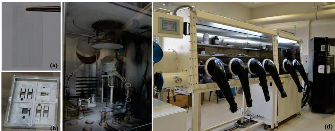
Figura 20: (a) Substrato litografado de óxido de índio-estanho (ITO); (b) máscara para deposição de alumínio; (c) câmara de evaporação térmica; (d) Glovebox da MBRAUN com sistema de deposição por sputtering e evaporação térmica resistiva. Figura produzida pelo próprio autor.
