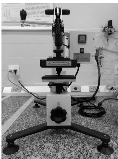
Figura 14: Prensa utilizada para transferir o toner para o ITO (à esquerda) e padrão desejado de Toner aderido ao ITO (à direita). Figura produzida pelo próprio autor (à esquerda) e figura retirada de Quirino 103 (à direita).
