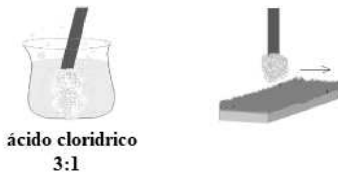
Figura 16: Remoção da pasta de zinco com solução de ácido clorídrico. Figura retirada de Dias. 104
