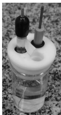
Figura 22: Eletrodo de trabalho, contra eletrodo e eletrodo de referência na solução de KCl. Figura produzida pelo próprio autor.
