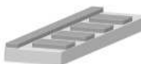
Figura 17: Padrão de ITO remanente após a corrosão. Figura retirada de Quirino. 103
