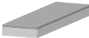
Figura 12: Lâmina de vidro/ITO comercial. Fonte: Figura retirada de Quirino. 103
