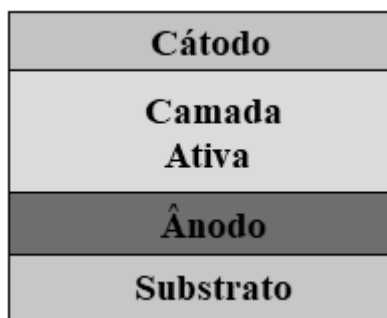
Figura 2: Arquitetura simplificada de uma OPV. Figura produzida pelo próprio autor.
