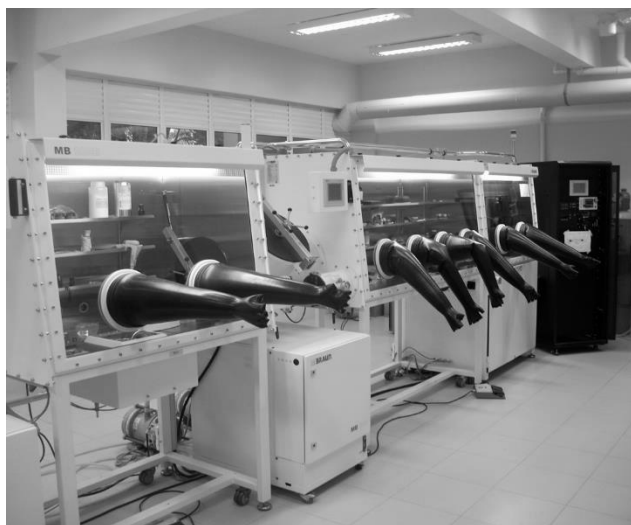
Figura 18: Conjunto de Glove boxes: à esquerda o sistema de deposição por spin coating e à direita sistemas de deposição por sputtering e evaporação térmica resistiva.
