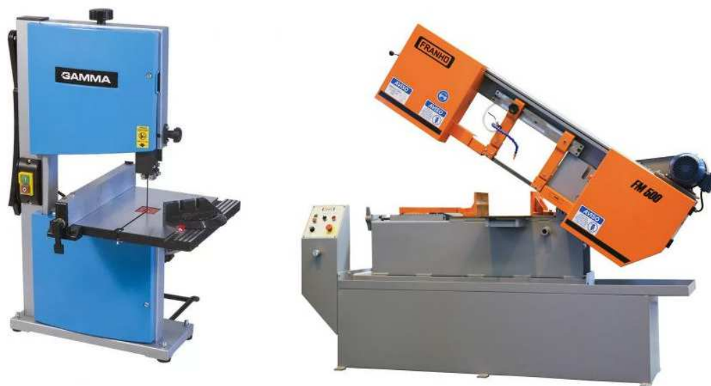
Figura 16 – Exemplos de Máquinas de Serra de Fita, à Direita, Horizontal, à Esquerda, Vertical
