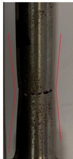
Figura 39 - Solda S1 normalizada evidenciando a estrição.
