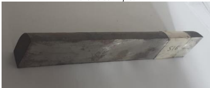
Figura 32 - Metade da amostra S16 não utilizada para confecção de corpos de prova para ensaio de tração.
