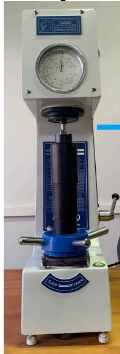
Figura 35 - Durômetro Rockwell normal analógico EQUILAM disponível no laboratório da Faculdade de Engenharia (UFJF).
