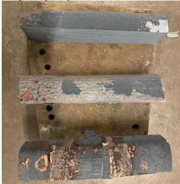
Figura 31 - Corpos de prova já resfriados (20 minutos com ar forçado).
