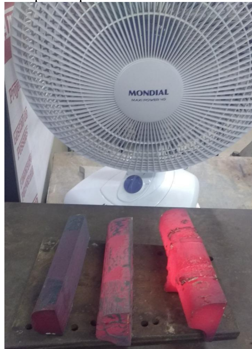
Figura 30 - Corpos de prova sendo resfriados com ar forçado.
