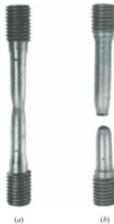
Figura 12 - Corpo de prova dúctil em ensaio de tração
