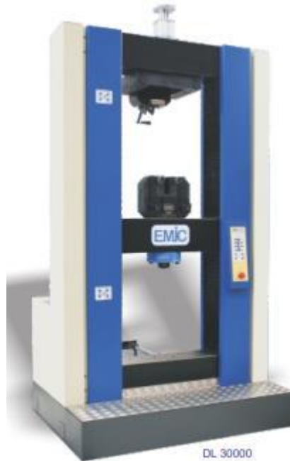
Figura 34 - Imagem ilustrativa da máquina de ensaio utilizada (Emic DL 30000).
