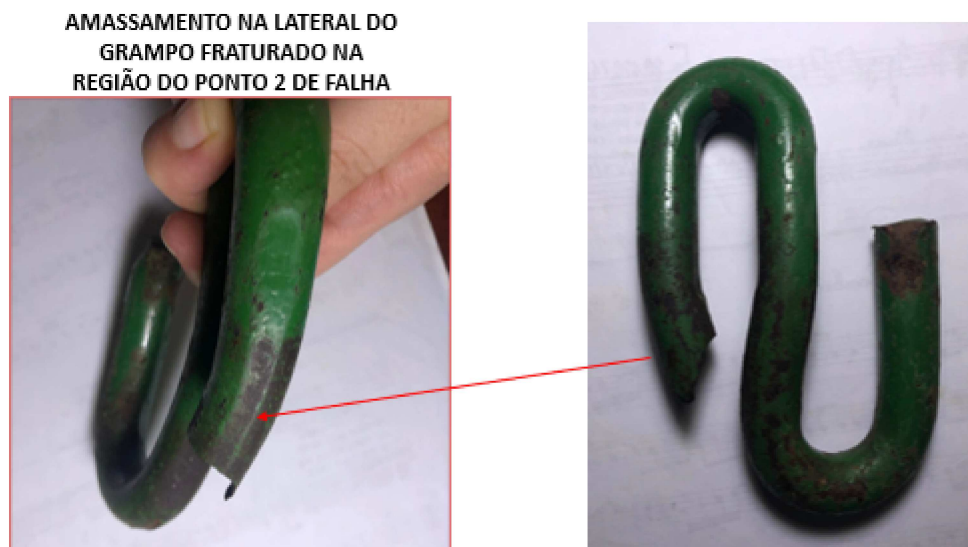
Figura 58 – Descontinuidade geométrica na região do ponto de falha 2
