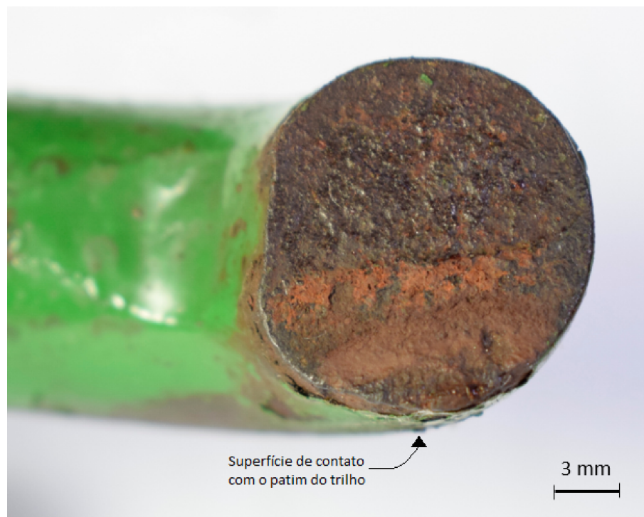
Figura 54 – Superfície de fratura da amostra A
