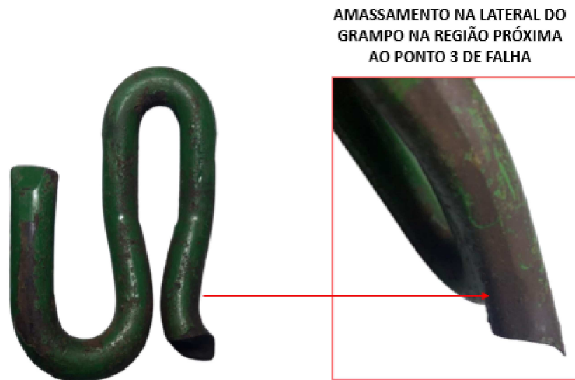
Figura 59 – Descontinuidade geométrica na região do ponto de falha 3
