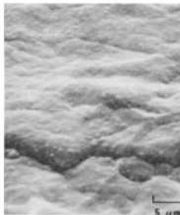
Figura 33 – Fratura por corrosão sob tensão que ocorreu por decoesão ao longo do plano de separação de uma liga de alumínio forjada.
