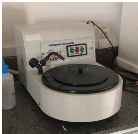
Figura 49 – Politriz utilizada para fazer o polimento da amostra.
