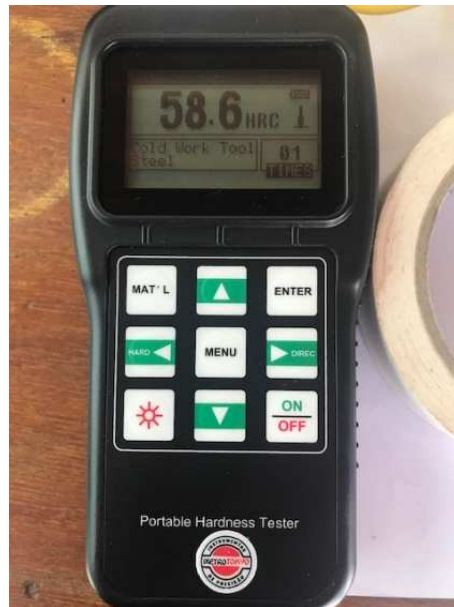
Figura 66 – Resultado da aferição da dureza em bloco padrão
