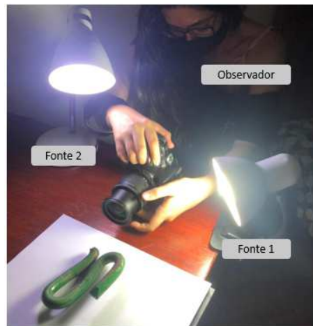
Figura 47 – Sistema de iluminação montado para registro fotográfico da superfície de fratura
