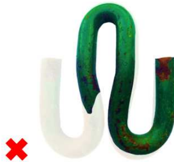
Figura 45 – Falha em grampo de fixação fastclip
