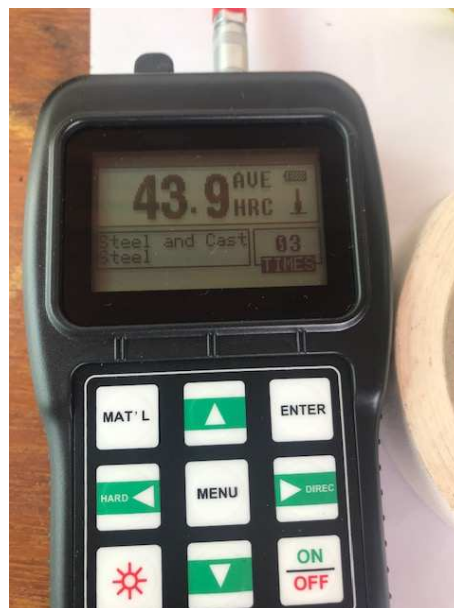
Figura 67 – Resultado da dureza média encontrada na superfície do grampo
