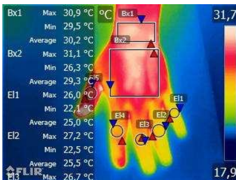
Figura 5 – Imagem termográfica representando os pontos utilizados para medição da temperatura da pele na mão das voluntárias
