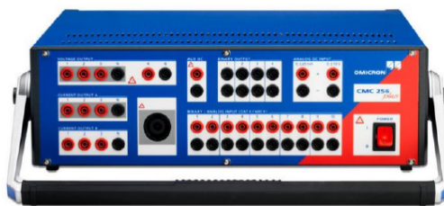
Figura 44: Modelo Omicron CMC-255-6 plus usada para reproduzir o sinal s_4(t) . Para a configuração dos sinais, estados com distúrbios são configurados com tempos de pré-evento, evento e pós-evento. Eventos de pré e pós, no caso, constituem sinais puramente senoidais de frequência e amplitudes fixas com 180 V e 60 Hz.
