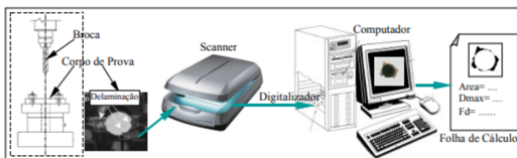
Figura 26 – Sistema proposto para análise digital da delaminação em materiais compósitos laminados.
