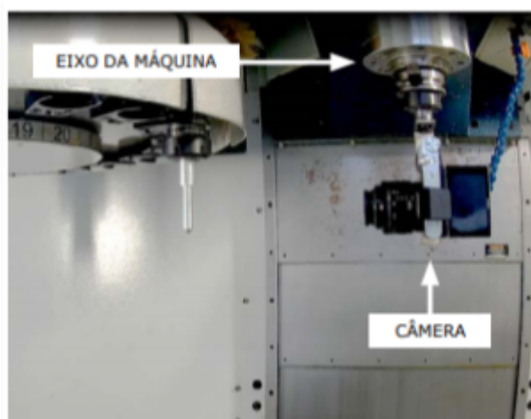
Figura 27 – Sistema de aquisição de imagens
