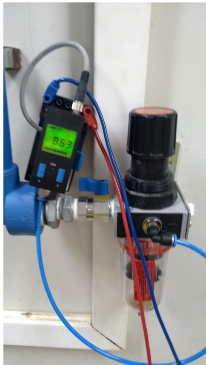
Figura 13 – Medidor de pressão digital conectado ao filtro de ar no experimento de perda de carga
