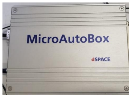
Figura 9 – Dispositivo MicroAutoBox ou dSPACE do LABSIM.
