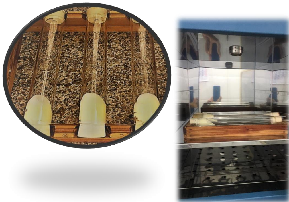
Figura 6 - Foto do teste de derretimento – tubos preparados para o aquecimento
