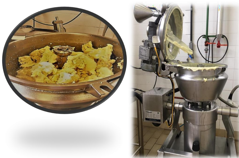
Figura 2 - Foto do equipamento de fusão - homogeneizadora-trituradora Geiger®, modelo GUMSK12E
