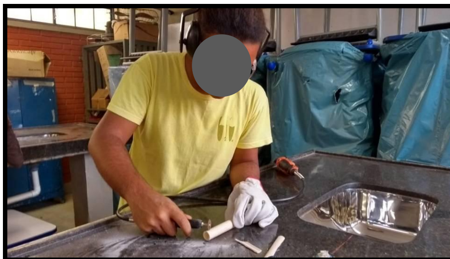
Figura 7 – Corte do tubo de PVC que compõe a estrutura do modelo de fêmur.
