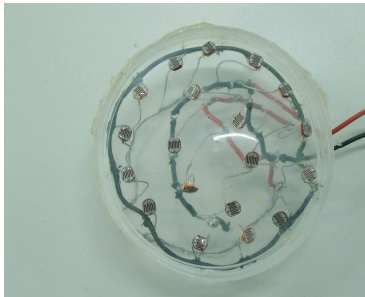
Figura 3: Sensores LDR ligados em paralelo para captação de luminosidade.
