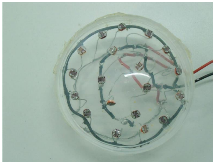
Figura 3: Placa composta de 18 sensores LDR ligados em paralelo para captação de luminosidade
