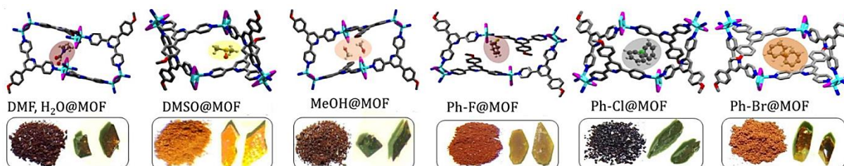
Figura 16 – Modulação por efeito de solvente em mudanças de características físicas de químicas em redes de coordenação
