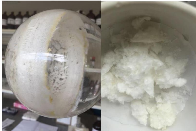
Figura 9- Precipitado formado no balão após rotaevaporação e filtrado
