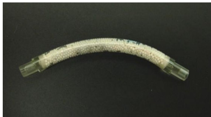
Figura 15: Reator tubular com enzima imobilizada (0,26 x 2,2 cm).
