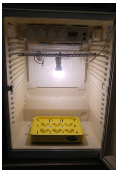
Figura 7: Câmara incubadora com lâmpada de LED e placa agitadora onde os béqueres com tratamentos foram incubados.
