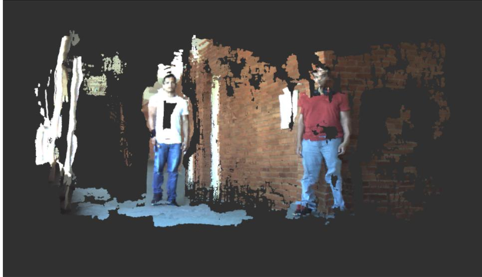
Nas Figuras 48 e 49 é possível observar reconstruções em 3D do ambiente interno do laboratório. É notável a qualidade visual das nuvens, porém existem buracos pela característica monocromática das paredes.
