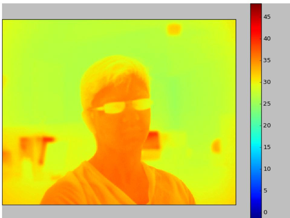
Como pode ser visto comparando os pontos do rosto com a escala ao lado, a confiança na medição está inferior à separação da marcação de 5 graus, o que é suficiente para apontar defeitos críticos em equipamentos inspecionados [52].
