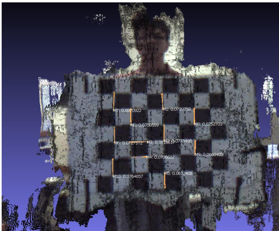
Pode-se com essa imagem ter confiança na ordem de centímetros sobre uma medição linear em um modelo final obtido pelo algoritmo. No caso, a média de 74,2 diferiu 0,8 milímetros do valor esperado (o qual também pode apresentar certas imperfeições), com um desvio padrão de 5,6 milímetros.
