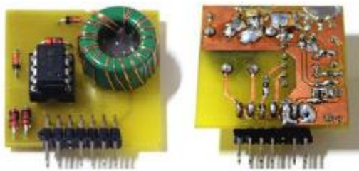
Figura 4.13: Placa do circuito de acionamento do driver de alta frequência. Adaptado de Almeida (2014).
