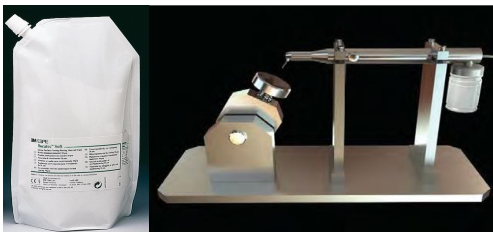
Figura 13- Rocatec Soft – partículas de óxido de alumínio de alta pureza de 30 \mu\text{m} , modificado com sílica ( \text{SiO}_2 ) (a)** e Equipamento posicionado no dispositivo metálico para padronização dos procedimentos de jateamento (b)**.
