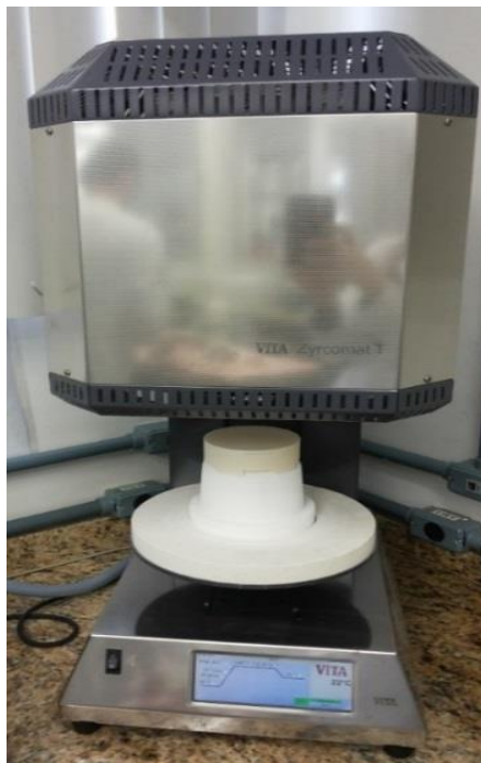
Figura 12- Forno Zyrcomat T utilizado para sinterização da cerâmica.
