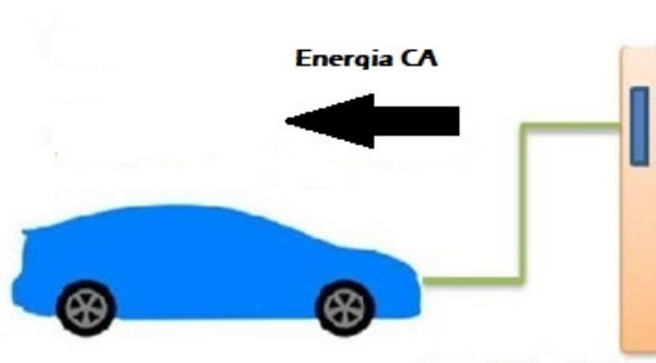
Figura 2.6 – Esquema de carregamento modo 1
