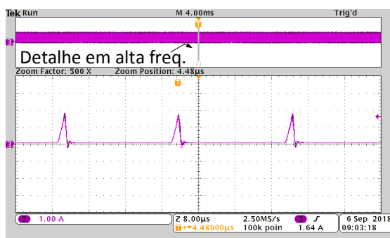
(b) Corrente no primário do transformador flyback (CH3 1 A/div).
