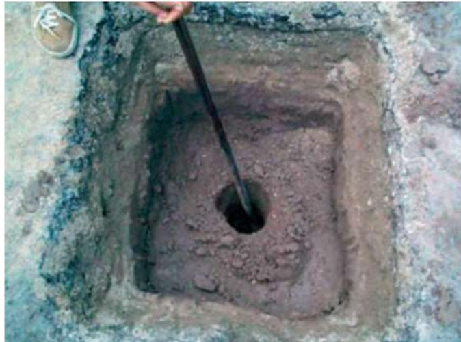
Figura 2.8 – Ilustração de poço de sondagem (Fonte: Bernucci *et al.*, 2008)
