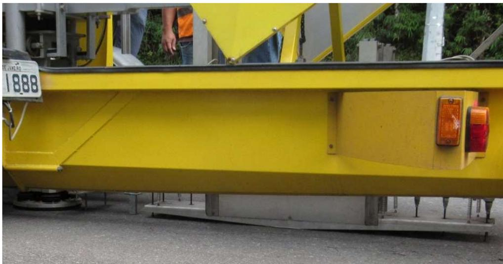
Figura 3.6 – Visão do sistema de leitura de deflexões na posição de operação (Fonte: Autor, 2018)
