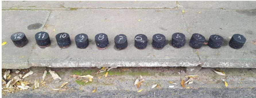
Figura 3.9 – Corpos de prova retirados do revestimento na prospecção (Fonte: Autor, 2018)
