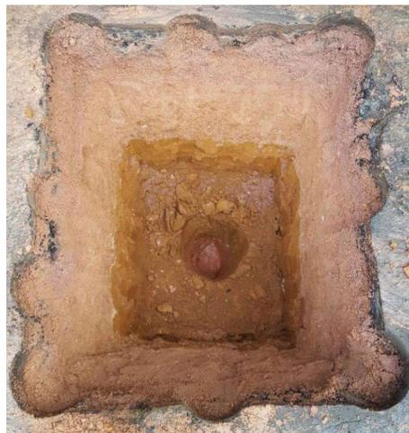
Figura 3.10 – Poço de sondagem executado no pavimento do anel viário da UFJF (Fonte: Autor, 2018)
