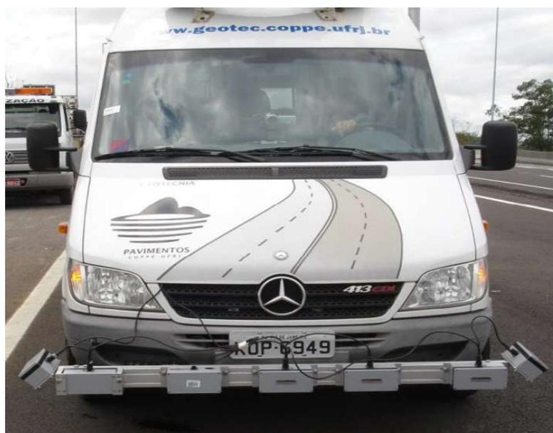
Figura 3.3 – Perfilômetro a laser instalado no veículo da COPPE/UFRJ (Fonte: Fritzen e Motta, 2018)
