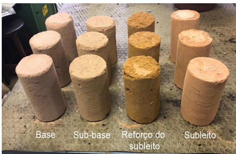
Figura 3.11 – Corpos de prova de amostras de solo utilizados nos ensaios de determinação do módulo de resiliência dos materiais das camadas do pavimento do anel viário da UFJF (Fonte: Autor, 2018)
