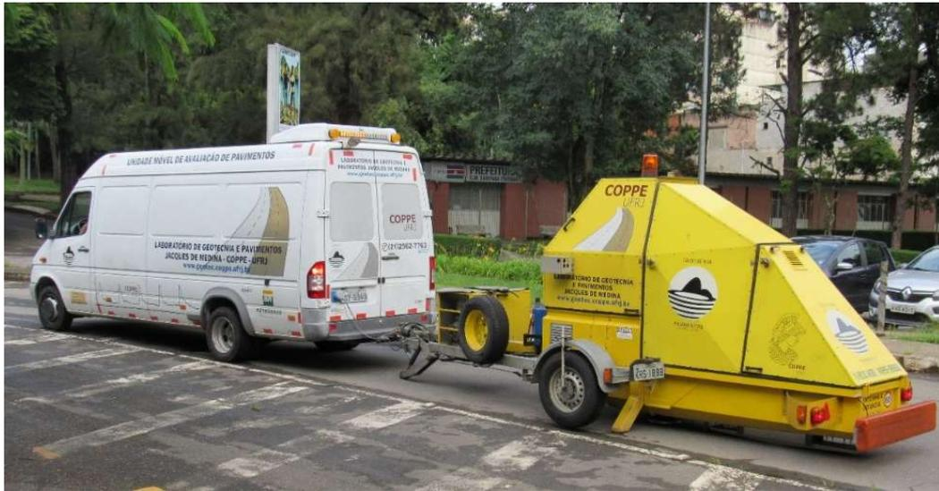
Figura 2.10 – Vista geral de equipamento FWD (Fonte: Autor, 2018)
