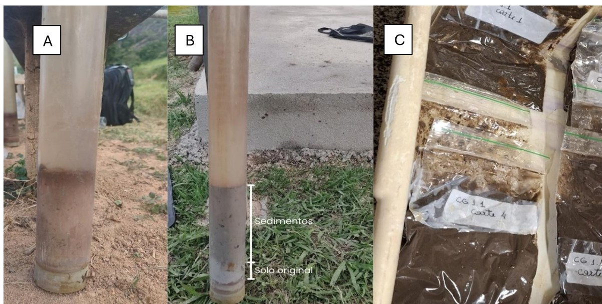
Figura 4. Testemunhos de camada sedimentar recuperados de viveiros escavados em duas propriedades distintas. (A) Testemunho de sedimento onde é possível identificar a estratificação entre o sedimento mais jovem e o sedimento mais antigo, já assentado: coleta realizada na região central do viveiro. (B) Testemunho de sedimento onde é possível identificar a estratificação entre o sedimento e o solo original, coleta realizada na região central do viveiro. (C) Envelopes herméticos em temperatura ambiente, em processo inicial de análise laboratorial.
