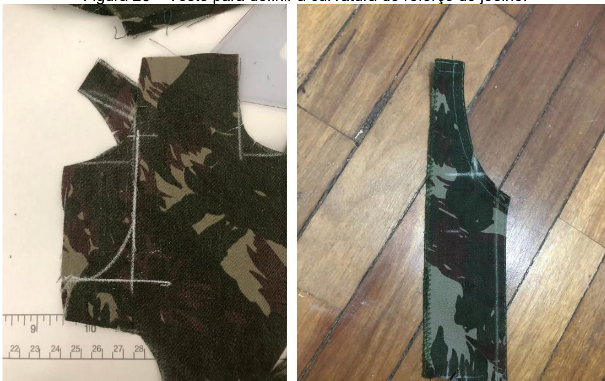
Figura 26 – Teste para definir a curvatura do reforço do joelho.
