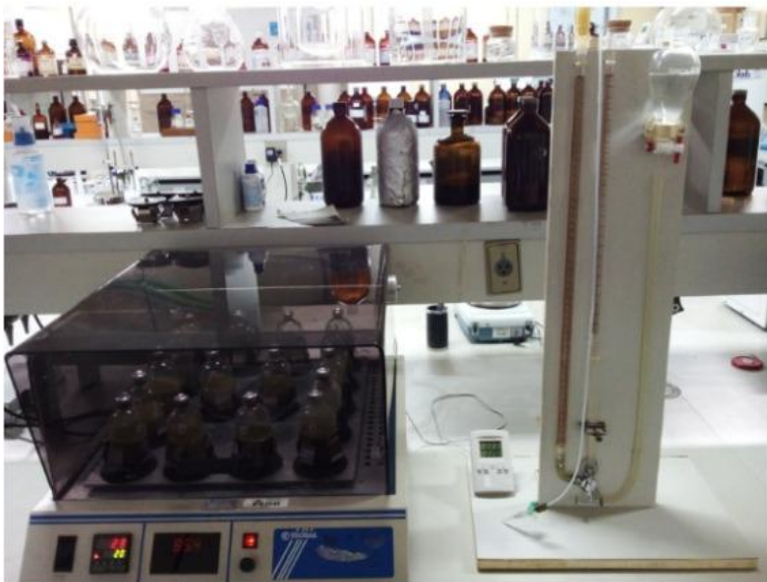
Figura 10: Montagem dos ensaios em batelada na incubadora shaker.
