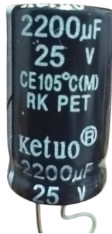
Figura 8 – Fotografia do capacitor eletrolítico de 2200 \mu\text{F} e 25 V.
