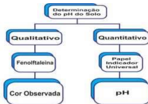
Figura 1: Esquema para determinação do pH do solo
