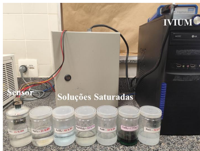
Figura 21: Aparato experimental montado para as medições elétricas contendo as soluções salinas saturadas, potenciostato e o sensor.
