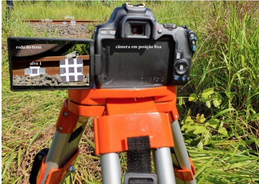
Figura 10 – Montagem do conjunto de monitoramento, composto de tripé e câmera à frente e alvos ao fundo, mostrando de forma esquemática instrumentação realizada por Mendes
