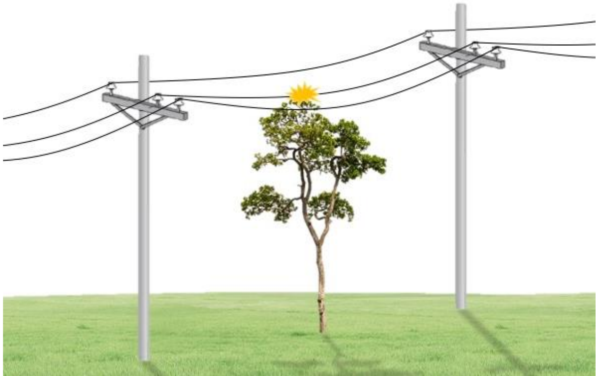
Figura 10 – Contato de um condutor energizado com uma árvore
