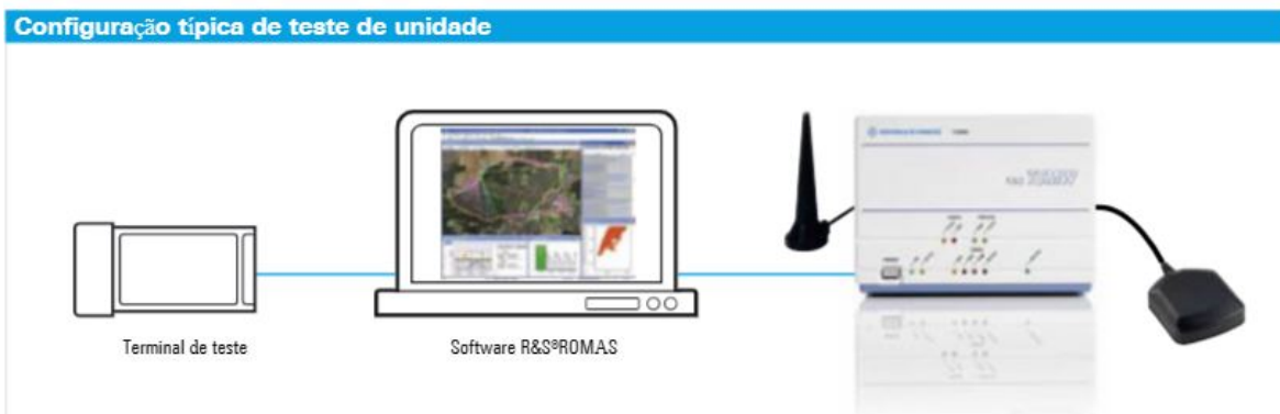
Figura 9 – Setup da coleta de dados realizada pelo drive test. Fonte: (SHWARZ, R. &, Rhode & Shwarz, 2017)
