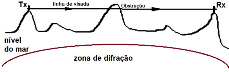
Figura 2 – Comunicação de Rádio ponto a ponto, sem visada direta. Fonte: Adaptada de (CASTRO, 2017)
