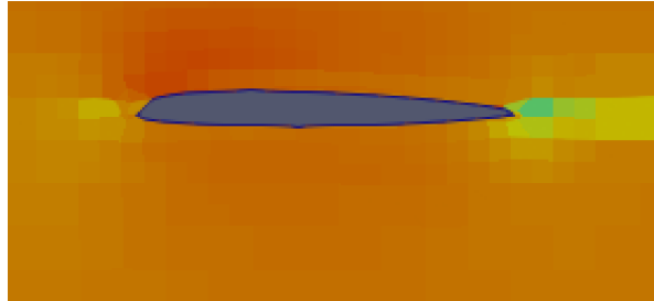
Figura 47 – Campo de velocidades na ponta da asa para um ângulo de ataque 2^\circ .
