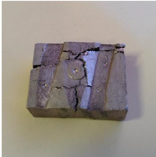
Figura 13 – Amostra 1 após o forjamento
