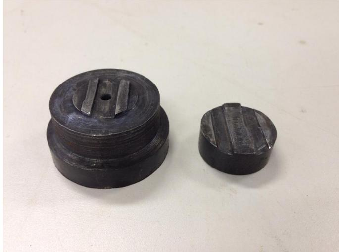
Figura 6 – Ferramenta utilizada no forjamento em matriz aberta.
