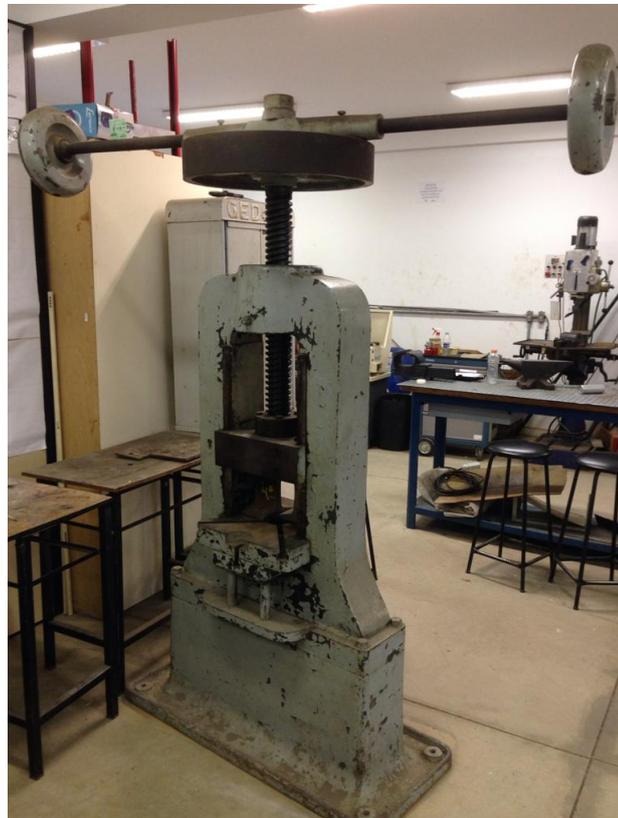
Figura 7 – Prensa manual do tipo parafuso.
