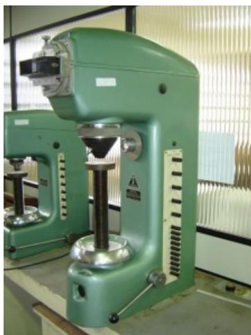
Figura 9 – Medidor de dureza Vickers
