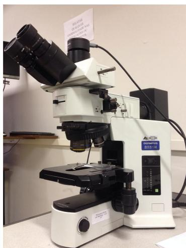
Figura 10 – Microscópio ótico Olympus modelo BX51M
