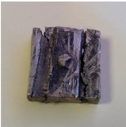
Figura 15 – Amostra 4 após o forjamento
